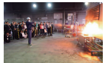
住宅用消火器による天ぷら油火災の消火実演 〔日本消防検定協会〕
