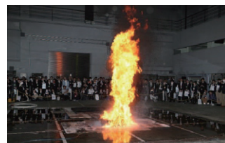
軽油の燃焼実験 〔消防研究センター〕
